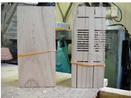
製材物から、規格サイズに木取り除く部分に鋸目を入れ乾燥したパーツ
