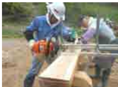
製材・・・2台の簡易製材機はフル稼働。間伐材を次々板・角材などに製材。用材としての質も悪くない、十分使えます
