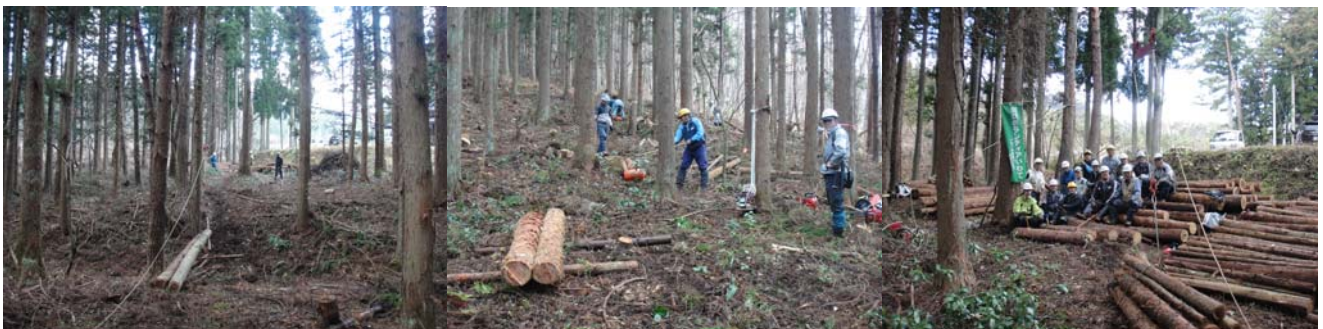
ワイヤーロープ架空索とロープウインチのセット集材
